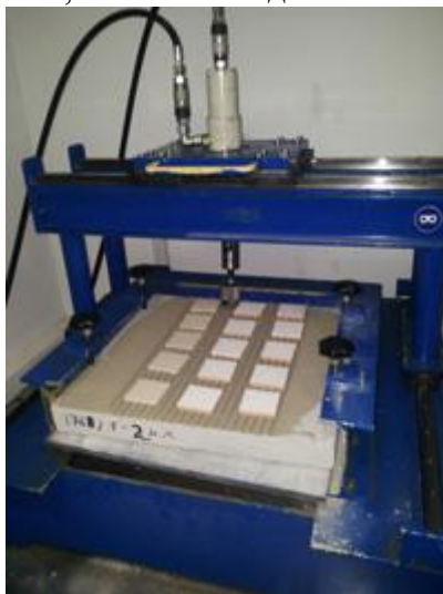
Рис. №1 Машина для определения прочности приклеивания Herion НВ 850
